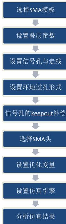
图 1: 高速连接器 SMA 封装的建模仿真优化流程
